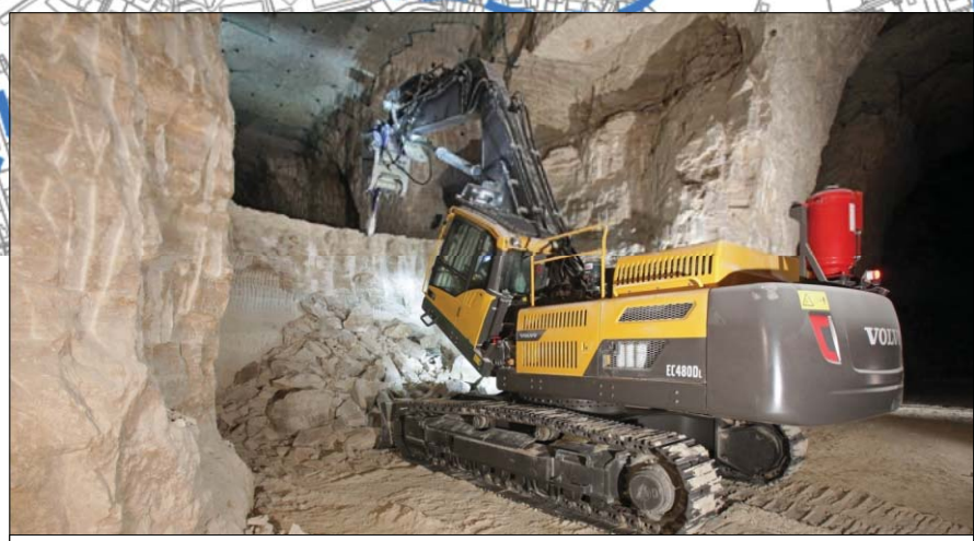
Abattage mécanique du gypse en souterrain au niveau des zones les plus sensibles, si les tirs de mines génèrent des vibrations > 5 mm/s (photographie carrière PLACOPLATRE de Vaujours (93))
